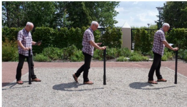
Abbildung 7.7: „Zickzack“-Scan in der Betriebsart „3D Ground Scan“
